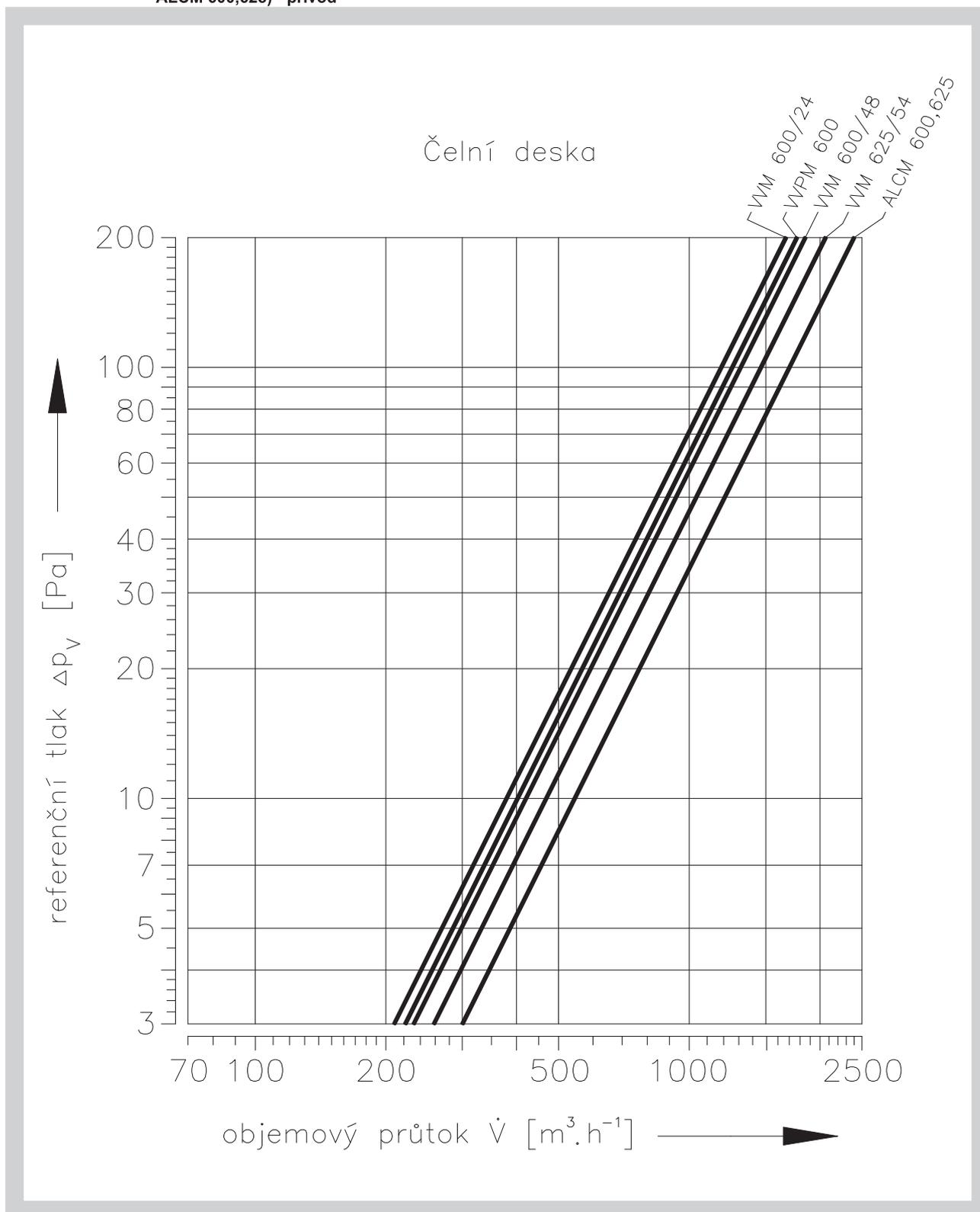
Diagram 5.1.2. Graf závislosti obj. průtoku na tlaku - přívod (VVM 600/24, VVM 600/48, VVM 625/54, VVPM 600, ALCM 600,625) - odvod
