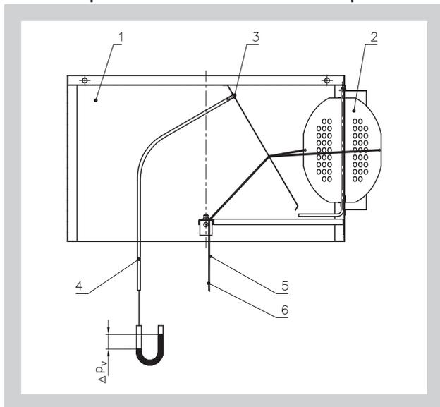
Obr. 8 Připojovací skříň s ovládáním regulační klapky pomocí lanek a s tlakovou sondou - odvod
