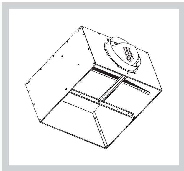
Obr. 2 Připojovací skříň s ovládním ovládním - přívod vzduchu
